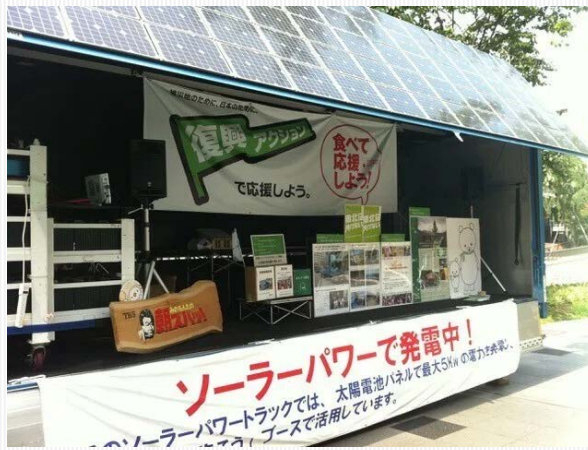
ソーラーパワートラック(トラックの荷台に5kWのPVを設置)
